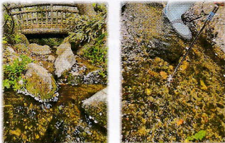
あずまや池出口水路 流速の測定(流速計による)
